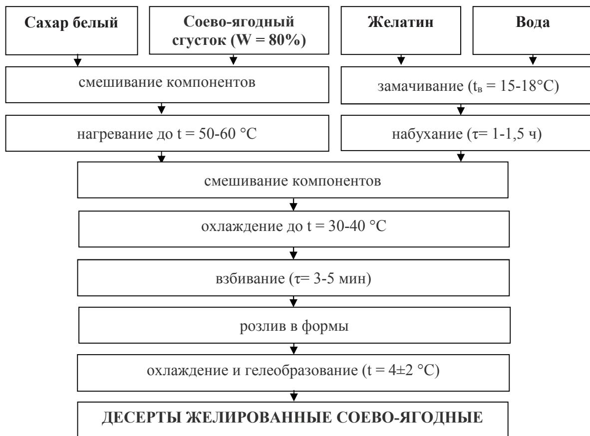
Рис. 1. Принципиальная технологическая схема приготовления желированных соево-ягодных десертов
