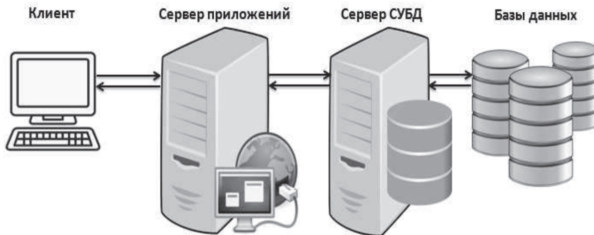
Рис. 3. Схема трехуровневой архитектуры взаимодействия в системе «клиент-сервер»
