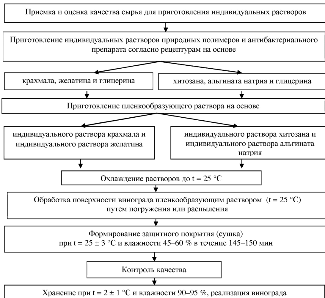
Рисунок 13 – Структурная схема приготовления и нанесения пленкообразующих покрытий на основе природных полимеров и антибактериального препарата
